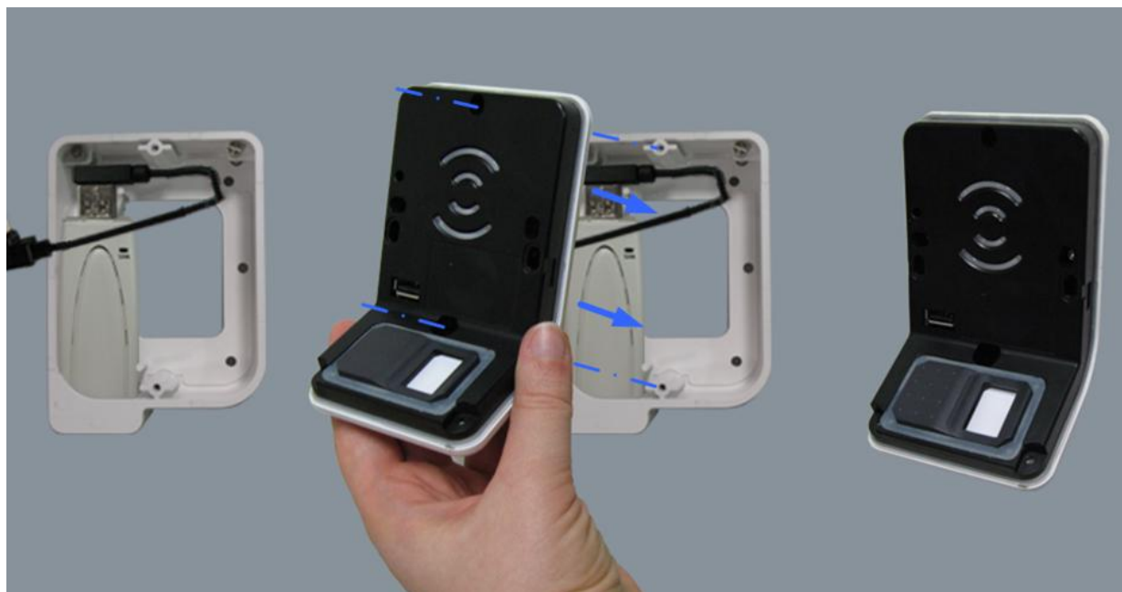
Figure 5 : Port USB arrière du terminal MorphoAccess® J Series avec un adaptateur Wi-Fi™
