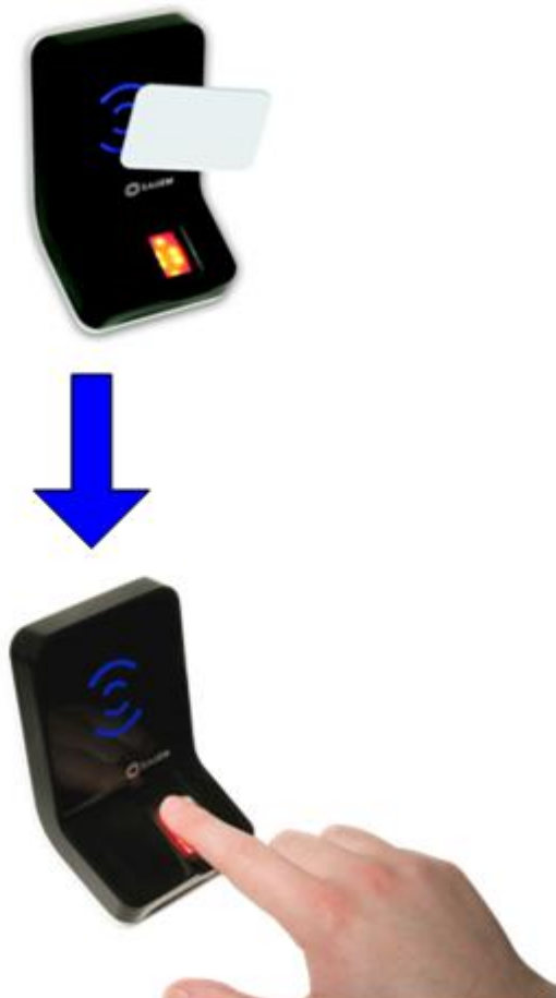
Figure 20 : Mode authentification avec données biométriques sur la carte
