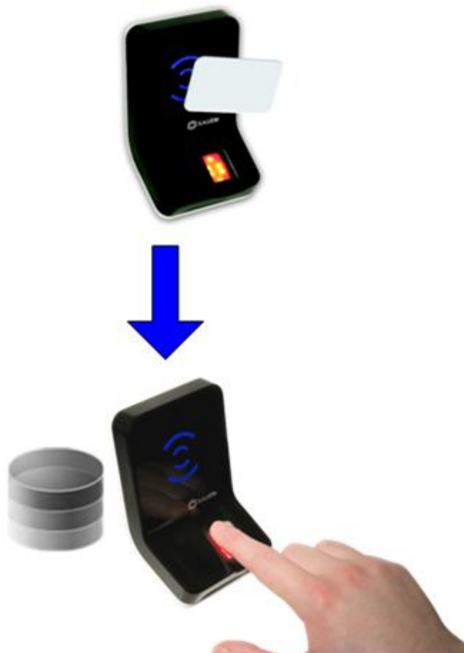
Figure 21 : Mode authentification avec données biométriques dans la base
