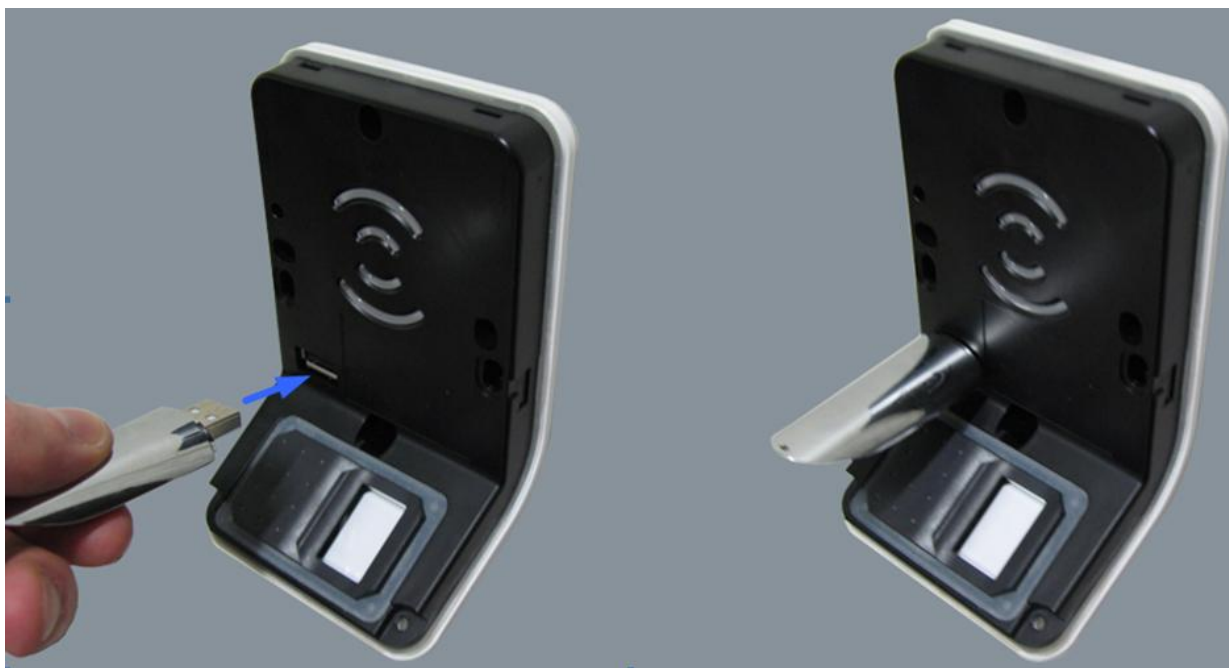
Figure 4 : Port USB frontal du Terminal MorphoAccess® J Series avec une clé mémoire USB
