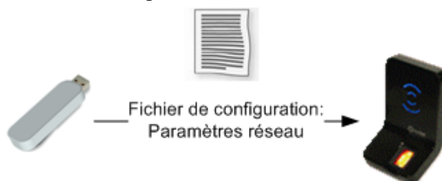
Figure 11 : Application du fichier de configuration au terminal
