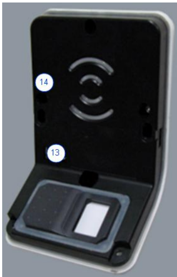
Figure 3 : Face avant du MorphoAccess® J Series sans la vitre amovible
